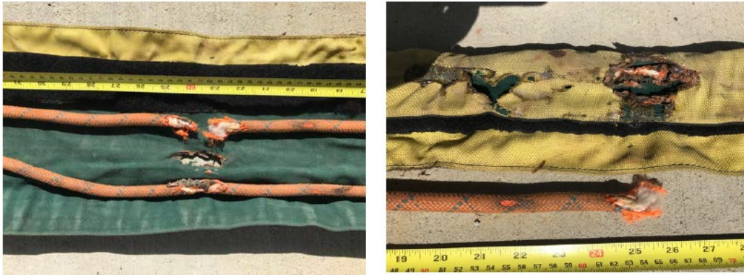
Figura 2: Protector de cuerdas y cuerdas dañadas
